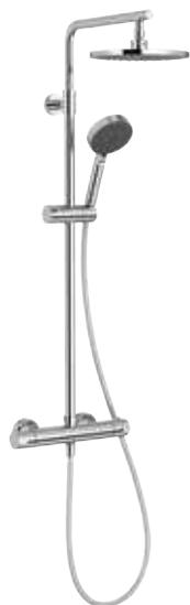
**E24322-CP Finition Chrome douche de tête ronde Ø 200 mm.** Douchette à main Brive Ø 100 mm, 5 jets (débit : 10 l/mn). Flexible de douche lisse anti-torsion 1600 mm, aspect métal. Inverseur intégré à la poignée. Butée de sécurité à 38°C. Température maxi inférieure à 50°C. Clapets anti-retour sur les alimentations. ECAU : E1/I C3 A2 U3
