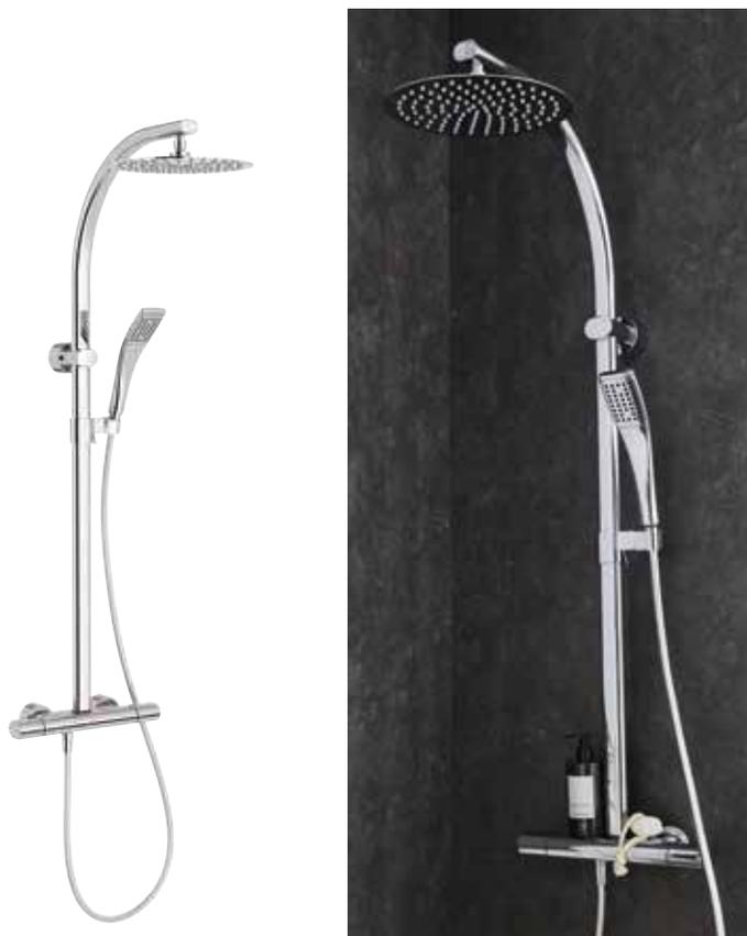
**E11717-CP Colonne de douche avec mitigeur thermostatique.** Douche de tête ronde en métal : 250 mm (débit : 10 l/mn) sur rotule. Inverseur sur poignée de débit du thermostatique. Butée de sécurité à 38°C. Température maxi inférieure à 50°C. Corps tiède. Poignées en métal. Coulisseau-support de douchette en métal, orientable. Flexible de douche lisse anti-torsion. Douchette à main EO Small. Clapets anti-retour sur les alimentations.
