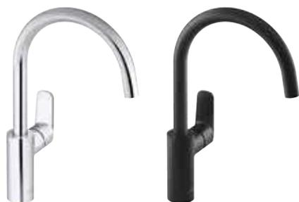
**E35686-4-CP Finition Chrome. Mitigeur évier, bec col de cygne orientable**, économie d'eau et d'énergie - butée sensitive à mi débit et démarrage eau froide. Douchette 2 jets (aéré / concentré). Fourni avec flexibles d'alimentation. Bague limiteur de température. Percement Ø35 mm. Débit limité à 10 l/mn. ECAU : E0 C3 A3 U3
