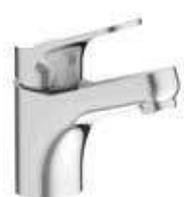
**E78110-4-CP Finition Chrome.** Avec flexibles d'alimentation. Système d'installation 5'35. Bague-limiteur de température. Tirotte latérale. Bonde de vidage en métal. Aérateur anticalcaire. Débit limité à 5 l/mn. ECAU : E00 Ch2 A3 U3
