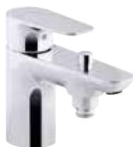
**E72284-CP Finition Chrome.** Avec flexibles d'alimentation. Bague-limiteur de température. Eco d'eau: butée sensitive. Inverseur automatique à bouton-poussoir. Flexibles d'alimentation (longueur 500 mm) avec raccords G1/2. Aérateur anti-calcaire "pièce". Clapet anti-retour sur la sortie douche. ECAU : E3|1 C2 A1 U3
