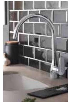
**E99477-CP Mitigeur évier avec cartouche C3** Pour des économies d'eau et d'énergie (levier centré = eau froide). Flexibles d'alimentation tournants. Bague-limiteur de température. Limiteur de débit sensitif. Bec tube orientable. Aérateur anticalcaire. Débit : 10 l/mn. Percement Ø 35 mm. ECAU : E0 C3 A1 U3
