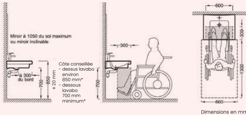
Un cabinet d'aisance accessible comporte un lave-mains dont le plan supérieur est situé à une hauteur maximale de 0,85 m ± 20 mm équipé d'une robinetterie dont la commande ou la cellule de déclenchement est située à plus de 0,40 m de tout angle rentrant de parois ou de tout autre obstacle à l'approche d'un fauteuil roulant.
