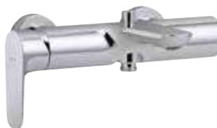
**E72282-CP Finition Chrome.** Inverseur automatique à bouton-poussoir. Aérateur anticalcaire pièce. Raccords et rosaces murales. Bague-limiteur de température. Limiteur de débit sensitif. ECAU : E3|1 C2 A2 U3
