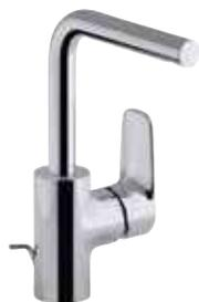
**E72278-CP Finition Chrome.** Avec flexibles d'alimentation PEX tournants. Bague-limiteur de température. Aérateur anticalcaire. Bonde de vidage métal. Tirette latérale. Débit limité à 5 l/min. Système d'installation facile et rapide 5|35". ECAU : E00 Ch2 A2 U3
