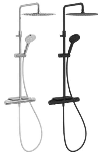
**E26589MA-CP Colonne de douche Métro ronde, mitigeur thermostatique, finition Chrome avec tablette antiglisse déclipable incluse, douche de tête ronde** ultrafine en métal Ø 300 mm. Douchette à main Ø 110 mm, 3 jets à bouton. Débit limité à 10 l/mn. Flexible de douche lisse anti-torsion 1600 mm aspect métal. Canne ajustable à l'installation. Butée de sécurité à 38°C. Inverseur intégré. Corps tiède. Clapets anti-retour sur les alimentations.
