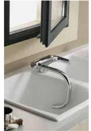
**E76250-CP Mitigeur évier finition Chrome,** bec tube orientable et rabattable pour installation devant une fenêtre, avec flexibles d'alimentation PEX. Bague-limiteur de température. Economiseur d'eau : butée sensitive. Aérateur anticalcaire. Débit : 9l/mn. Percement Ø 35 mm. Hauteur bec rabattu : 85 mm. ECAU E0 C2 A2 U3
