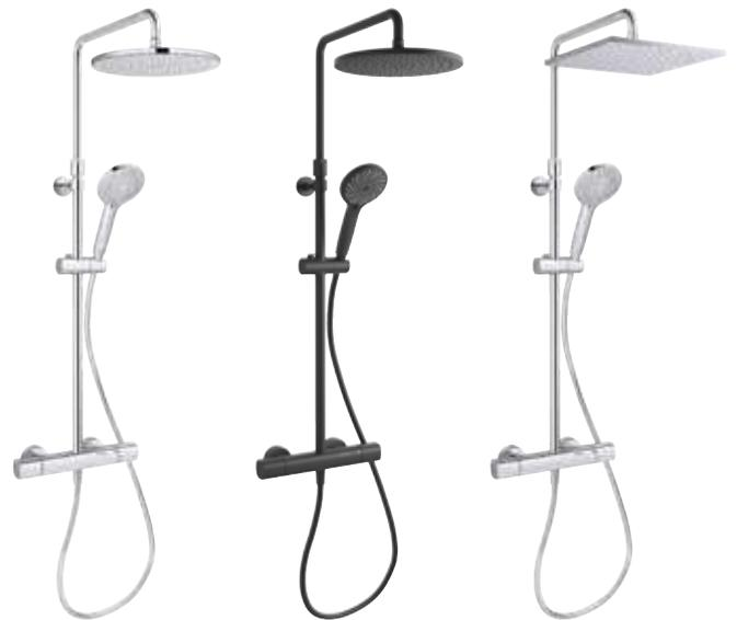
**E35678MA-9-CP Finition Chrome Douche de tête ronde Ø 245 mm** Économie d'eau. Butée escamotable à mi débit. Butée de confort à 38°C. Température maxi inférieure à 50°C. Corps tiède. Inverseur intégré dans la poignée. Flexible lisse anti-torsion 1600 mm. Douchette à main Ø110 mm, 3 jets (débit 7 l/mn). Canne et patère ajustables en hauteur à l'installation. Clapet anti-retour sur les alimentations.
