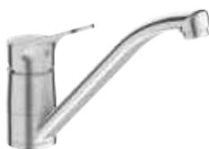
**E78115-4-CP Mitigeur évier, bec profilé orientable** avec cartouche C3 à économies d'eau et d'énergie. Bague-limiteur de température. Aérateur anti-calcaire. Débit limité à 10 l/mn.
