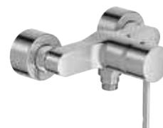
**E45532-CP Chrome.** Inverseur automatique verrouillable. Bague-limiteur de température. Raccords et rosaces murales. Aérateur anticalcaire intégré et incliné. Clapet anti-retour sur sortie douche. ECAU E3/I C2 AI U3
