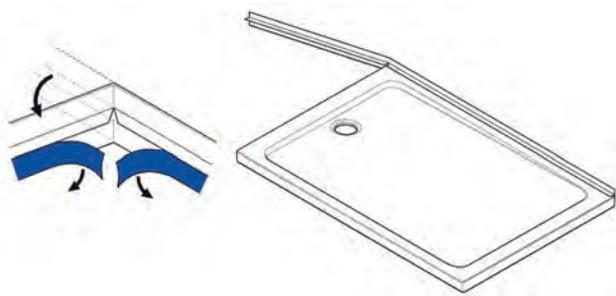
En plus du joint silicone, le joint périphérique adhésif permet d'assurer une étanchéité supplémentaire et durable entre le receveur, le mur et le carrelage.
