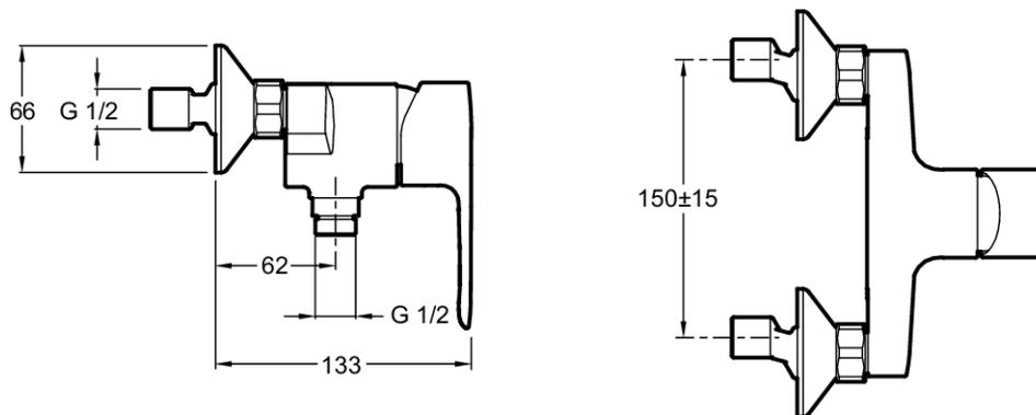
Descriptif CCTP : Mitigeur douche mural. E16029-4. Collection : JULY. POIDS : 1,4 kg. MATÉRIAU : Métal. TYPE D'INSTALLATION : 2 trous. NORMES ET RÉGLEMENTATIONS : NF : IA - ECAU : E1 C2 A3 U3 - Ge3 - ACS : 10 ACCLY 113. TYPE : Mitigeur. DÉBIT (L/MN SOUS 3 BAR) : 14 l/mn. RACCORDS : Avec raccords et rosaces murales. MÉCANISME : Cartouche à disques céramique. ENTRAXE (MM) : 150 ± 15. DURÉE GARANTIE (ANNÉES) : 5. Bague limiteur de température.. Economiseur d'eau : butée sensitive..
