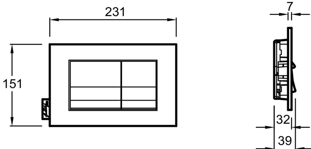
Descriptif CCTP : Plaque de commande, double touches rectangulaires. E20858. Collection : Hors collection. DIMENSIONS : 23,10 x 15,10 cm. POIDS : 0,5 kg. MATÉRIAU : N/A. TYPE D'INSTALLATION : Mural. NORMES ET RÉGLEMENTATIONS : NF.
