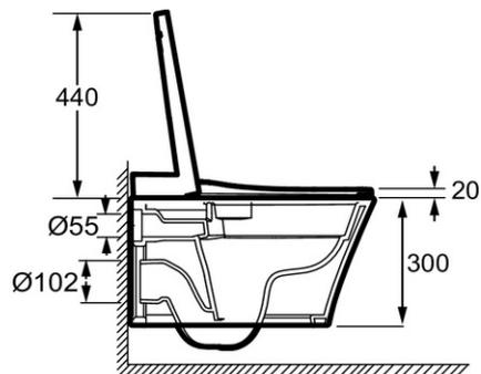
Descriptif CCTP : Cuvette suspendue lavante SANS BRIDE + télécommande + abattant. E28072. Collection : SEINE. DIMENSIONS : 57 x 37,50 cm. POIDS : 1 kg. MATÉRIAU : Céramique. TYPE D'INSTALLATION : Suspendu. LONGUEUR/PROFONDEUR : Standard. ÉVACUATION : Encastrée. FORME : Arrondie. CONSOMMATION D'EAU : Standard 3/6 L. HAUTEUR : Standard. TYPE DE BRIDE : Sans bride.
