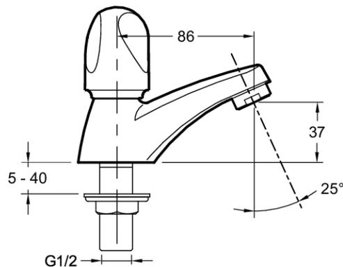
Descriptif CCTP : Robinet indépendant (eau froide). E72922. Collection : GALÉO CD. POIDS : 1,5 kg. MATÉRIAU : N/A. TYPE D'INSTALLATION : 1 trou. NORMES ET RÉGLEMENTATIONS : NF : II - EAU : E1 A1 U3 - ACS : 15ACCLY265. DÉBIT (L/MN SOUS 3 BAR) : 10 l/mn. SAILLIE DU BEC (MM) : 86. MÉCANISME : Têtes à disques céramique. DURÉE GARANTIE (ANNÉES) : 5. Poignée eau froide en métal.
